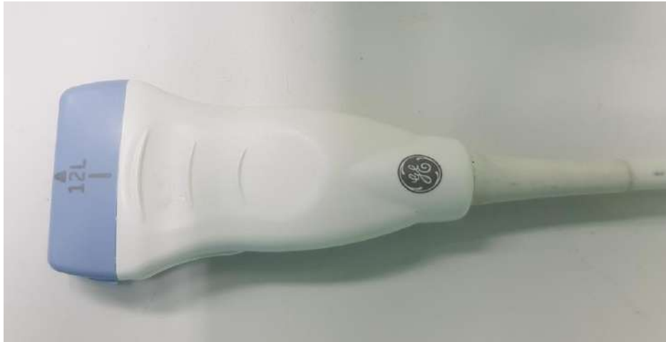
Рисунок 6 – Линейный ультразвуковой датчик для эпияортального сканирования
